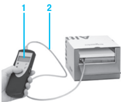
Конфигурирование ПЧ в упаковке с помощью мультизагрузчика WW3 A8 121+ кабель WW3 A8 126
